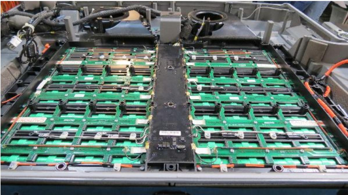
La HVTB es una fuente de energía de CC de 330 voltios (rango de funcionamiento de 216-397 voltios) que recibe energía eléctrica de alto voltaje cuando es requerido de la eCVT. La batería suministra energía eléctrica de alto voltaje a la eCVT, el convertidor de CC/CC y/o el módulo del compresor del aire acondicionado (ACCM). El sistema HVTB está conectado a un sistema de tierra flotante que lo mantiene aislado del sistema de 12 voltios del vehículo.
