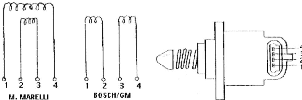
Se sabe que los Motores Paso a Paso son comandados por un circuito electrónico perteneciente a la computadora y su accionamiento es producido por pulsos positivos de forma rectangular que son aplicados a sus bobinas en una secuencia determinada, para que su vástago se extienda y en una secuencia inversa para que este se retraiga.
