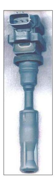
Si analizamos el esquema eléctrico de esta bobina vamos a encontrar que debe tener una masa un positivo y una señal (Pulsos provenientes del PCM).
