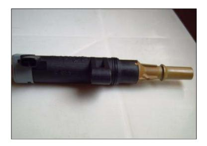
La configuración eléctrica de este tipo de bobinas permite un arreglo en el cual se cuenta con un positivo de contacto, una masa del PCM, y una salida de alta tensión hacia la respectiva bujía.
