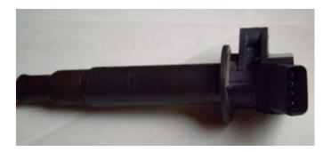
Para analizar el funcionamiento de esta bobina, lo primero que se debe tener claro es que la forma que se utiliza para generar la chispa es exactamente igual al explicado en las bobinas con 3 cables (Explicada en el ejemplo anterior), con lo cual lo único que las diferencia es que la de 4 pines envía una señal al PCM cada vez que se genera una inducción en el primario.
