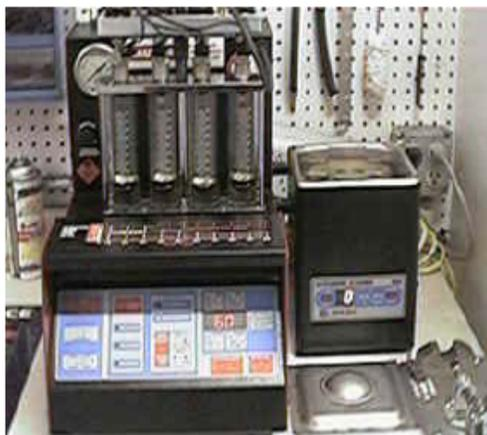
**Banco de Inyectores junto a un equipo de lavado por ultrasonido**
