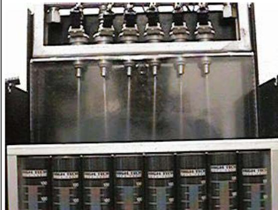
**Conjunto de inyectores pulverizando en probetas bajo la acción de un generador de pulsos.**
