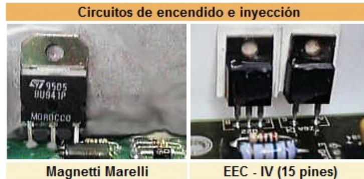
Si pueden ser remplazados por transistores que están en el mercado. Para probarlos recomiendo que se haga sobre el circuito del controlador en funcionamiento dado que con el tester en la posición de diodo a veces no se ve su falla.
