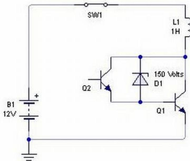
Cuando la tensión en el colector llega a 150V pone al Zener en conducción y se re-excita la base. De esta forma el transistor quiere volver a conducir y se corta el pico de extra tensión. Esta aplicación es más confiable dado que se maneja una corriente mucho menor por el Zener, por estar de por medio el transistor con su ganancia correspondiente.
