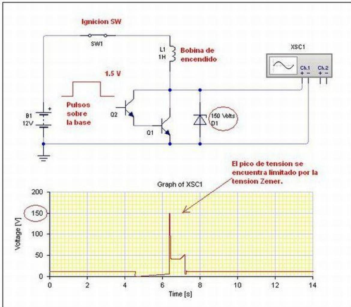
Cuando el pico de tensión producido por la auto inductancia de la bobina aparece, el Zener limita la tensión al valor Zener, cortando el pico en ese máximo de tensión.
