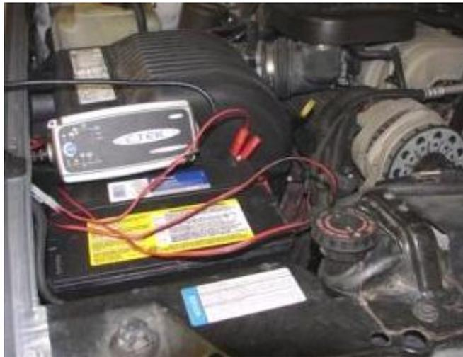
Se recomienda usar un cargador pequeño como el que se ve en pantalla, este equipo entrega aproximadamente 5 Amps de corriente los cuales son suficientes para mantener la batería en un voltaje mayor que 13 volts. Revisar el estado de los terminales de la batería, si no se presenta bien, remplazarlos es lo mejor o al menos limpiarlos.
