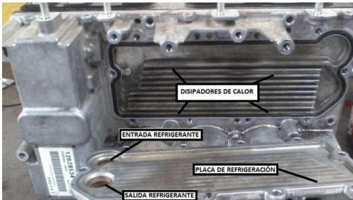
FIGURA 1: SISTEMA DE ENFRIAMIENTO DEL MODULO
