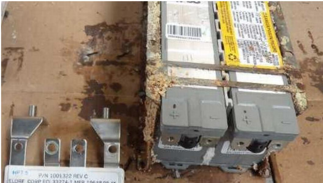
FIGURA 5: PACK DE BATERIAS DETERIORADO
