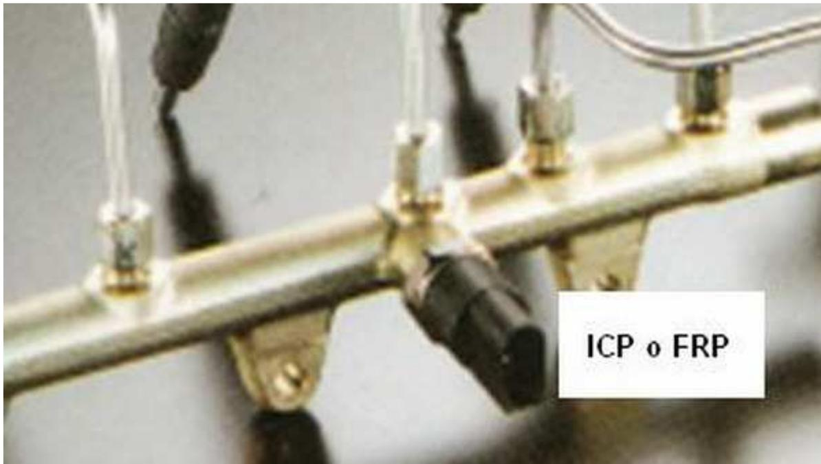
El sensor de presión dispone de 3 cables de conexión con el PCM, tal como ocurre con otros sensores de presión.
