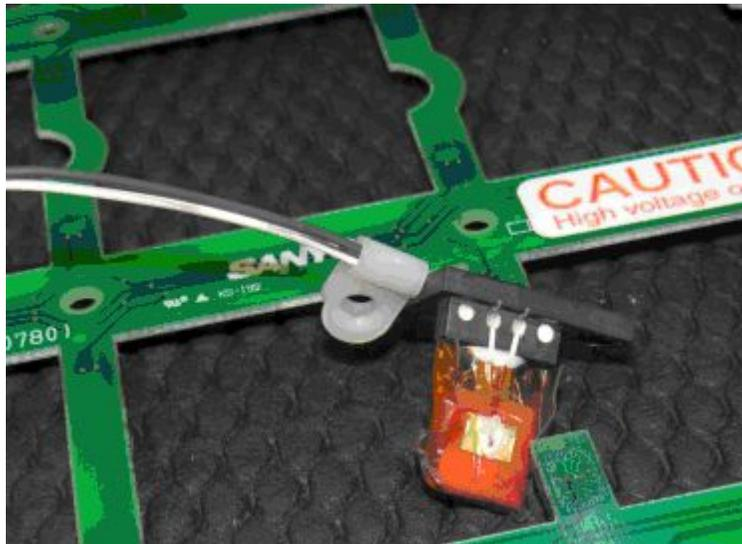
Para ello procedemos de la misma manera colocamos el tester entre sus extremos y obtenemos un valor de 9.05 K $\Omega$  a temperatura ambiente solo le acercamos un poco la pistola de calor y vemos que la resistencia va a un valor de 7.8K $\Omega$ , este sensor es muy sensible y del tipo NTC.
