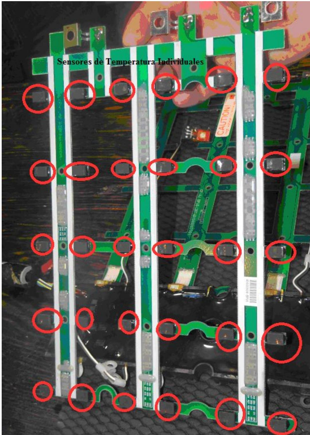
Por cada parte vienen 30 sensores estos que se conectan como una matriz, de tal manera que van hacia el módulo central 11 cables, más 3 más que son los que captan el voltaje en los puentes de esta sección.
